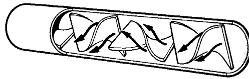
9.4. ábra. Csővezetékbe épített spirállemezes keverő-habaró elem
